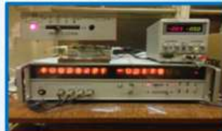
Стенд для измерения вольт-фарядных характеристик плёночных структур.
