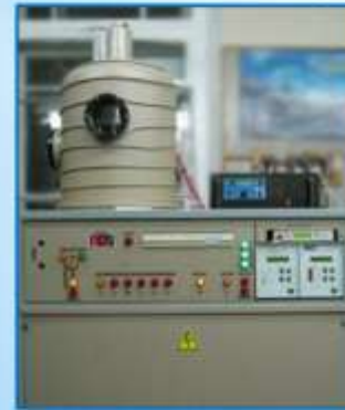
Модернизированная установка для вакуумного напыления (DC магнетрон)
